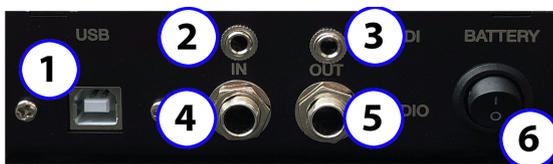
1. **Connessione USB** (MIDI Class Compliant). Il connettore USB è utilizzato anche per effettuare la ricarica.
