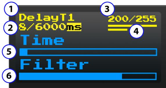
1. **Nome Menu.** Indica il nome dell'effetto o del synth sulla quale si sta operando, tutti gli effetti possono funzionare simultaneamente a prescindere dal menu attivo anche in aggiunta a suoni sintetizzati dall' SX-I stesso.
